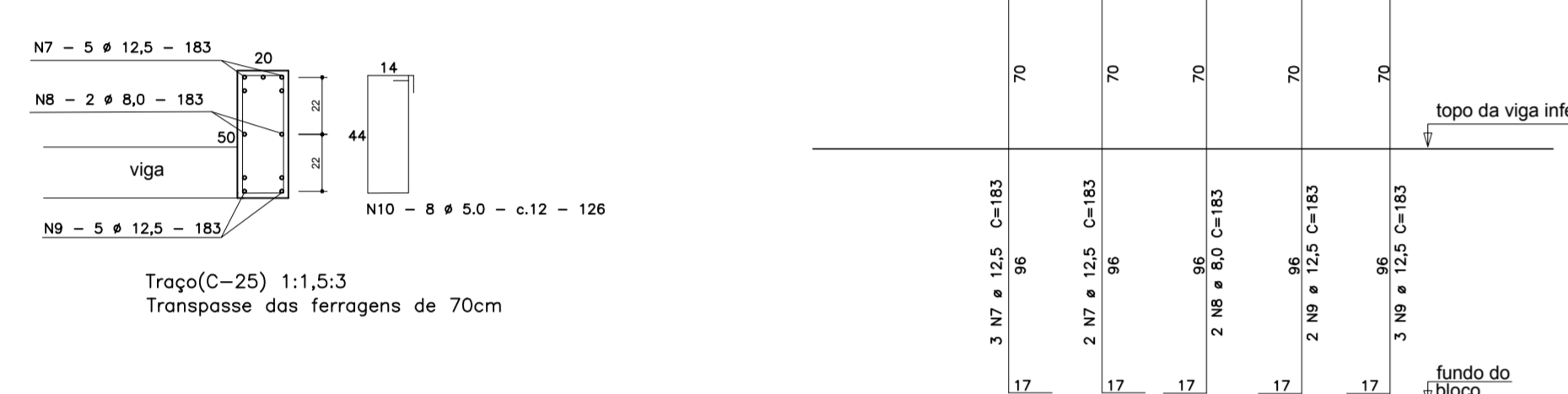
Armação dos arranques (10x) escala 1:25
